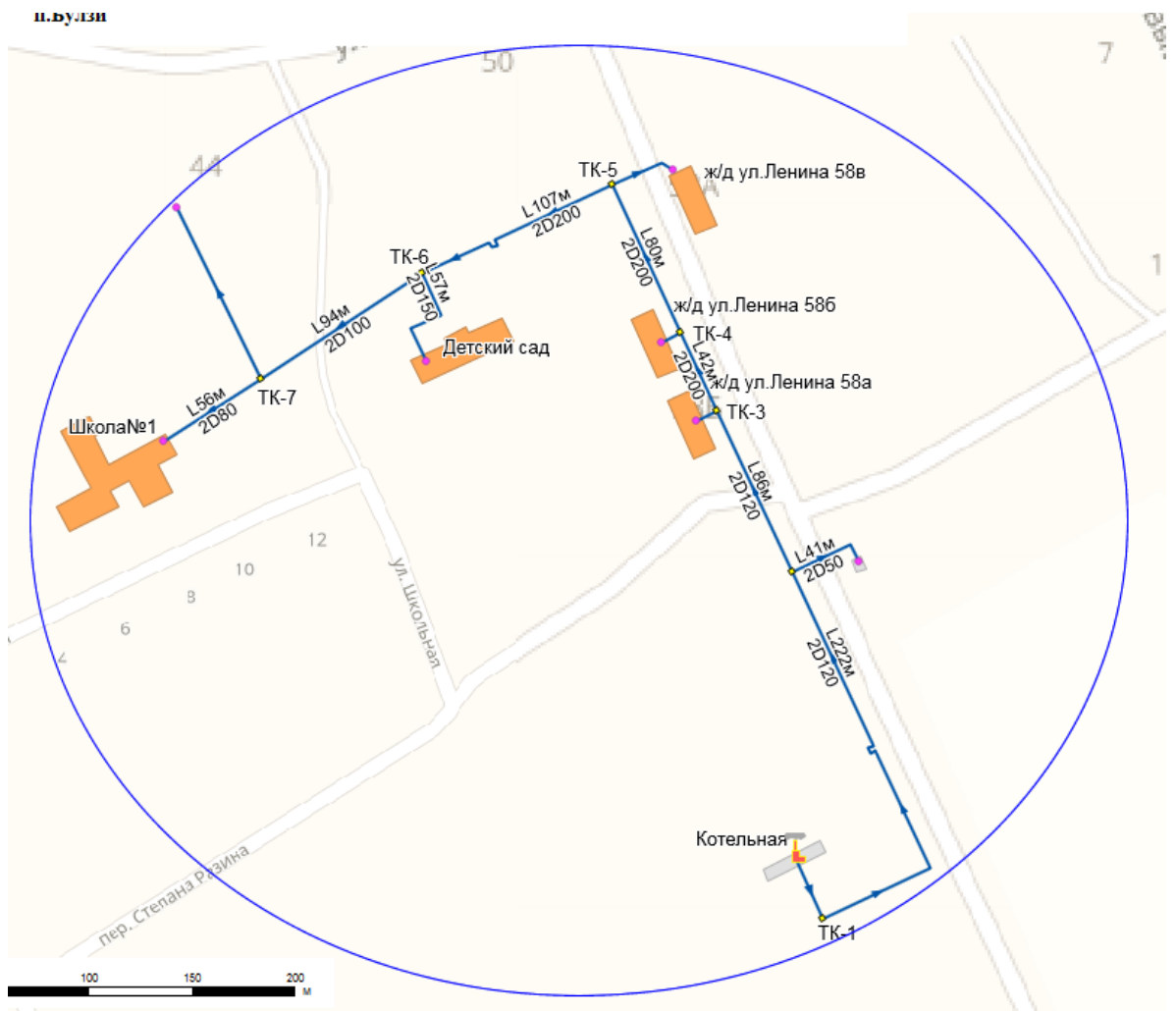
Рисунок 3. Радиус эффективного теплоснабжения от котельной
